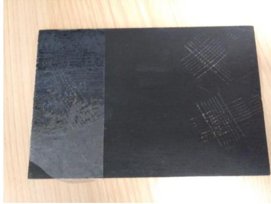
**Figura 35. Adherencia sobre tablero contrachapado.**
