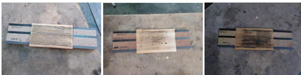
Figura 65. Aspecto de las probetas tras proceso de chapado en caliente.
