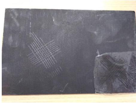
Figura 42. Probeta de MDF con “Pintura 3”.
