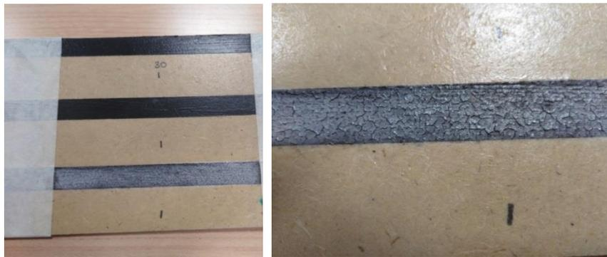
**Figura 54. Probeta sobre MDF, con fondo base agua.**
