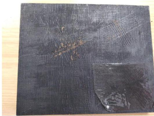
Figura 39. Probeta de contrachapado con "Pintura 3".
