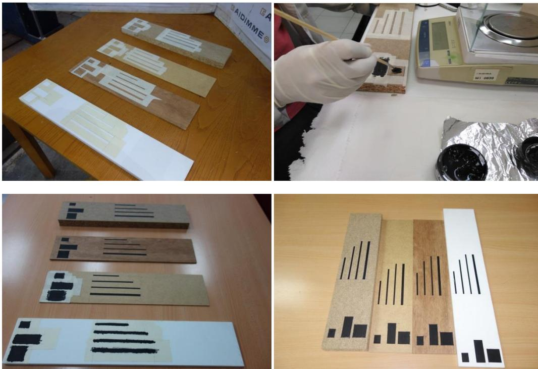
Figura 2. Proceso de aplicación de pintura conductora de la electricidad.
