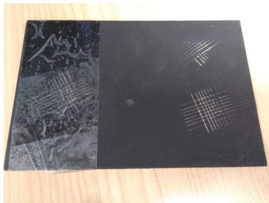
**Figura 34. Adherencia sobre tablero MDF.**
