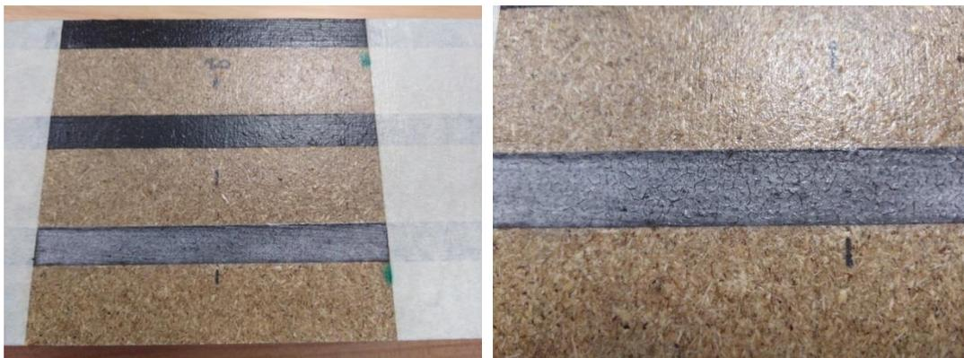
Figura 52. Probeta sobre aglomerado, con fondo base agua.
