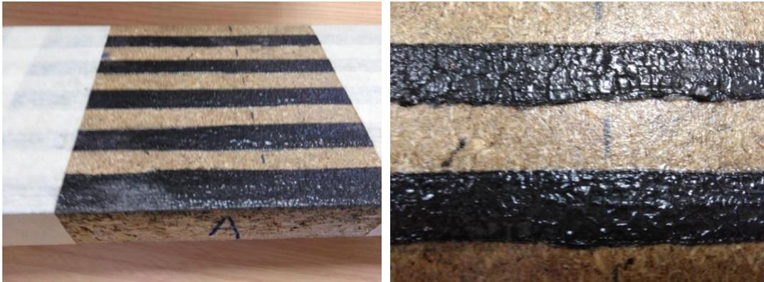
Figura 46. Probeta de barniz al agua sobre aglomerado.
