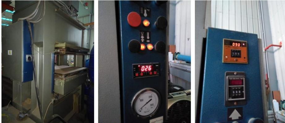
Figura 63. Imágenes de prensa de platos calientes utilizada.
