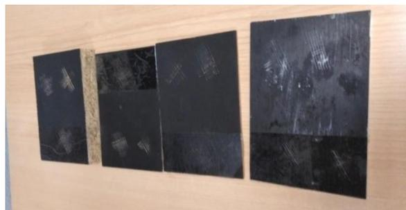
**Figura 32. Probetas tras ensayos de adherencia.**
