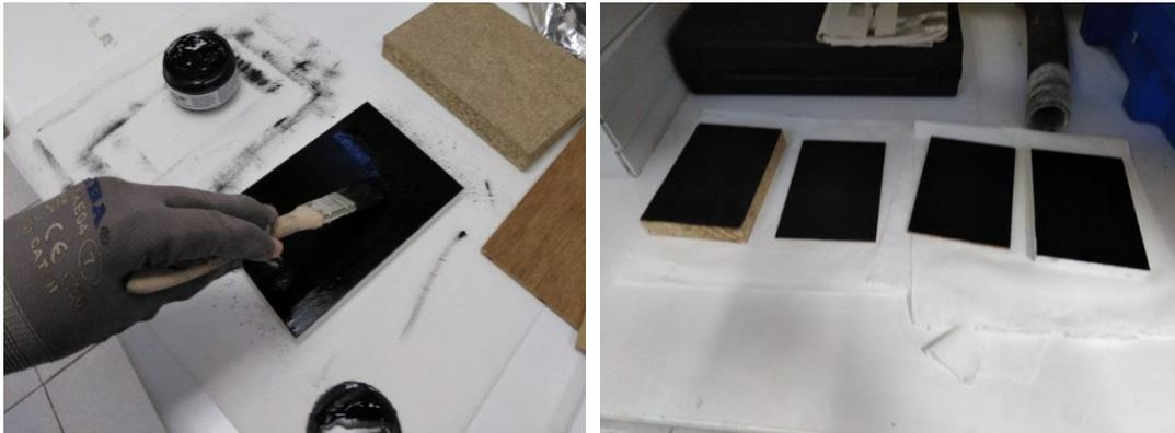
**Figura 31. Generación de probetas para pruebas de adherencia.**
